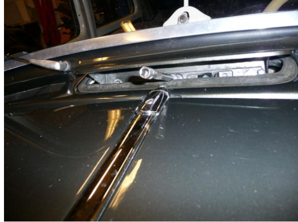
Die drei Bolzen mit 8mm Steckschlüssel einstecken
