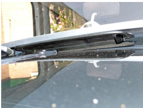
Dichtung unter Klappe sichtbar
