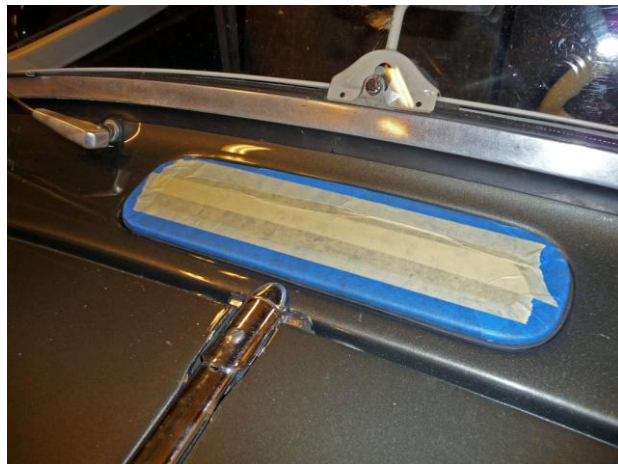
48 Stunden zum Trocknen - Klappe abgedeckt
